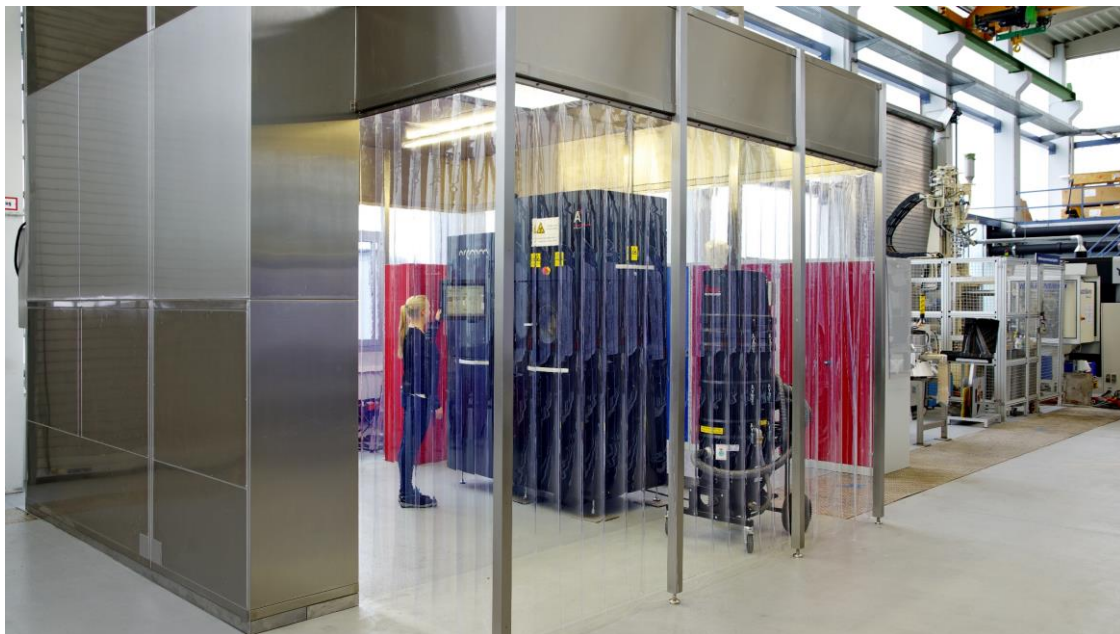
Anlage für das selektive Elektronenstrahlschmelzen (ARCAM A2X, GE Additive) mit Reinluftkabine am neuen Standort in der technischen Halle 1 (Neue Materialien Fürth GmbH)
