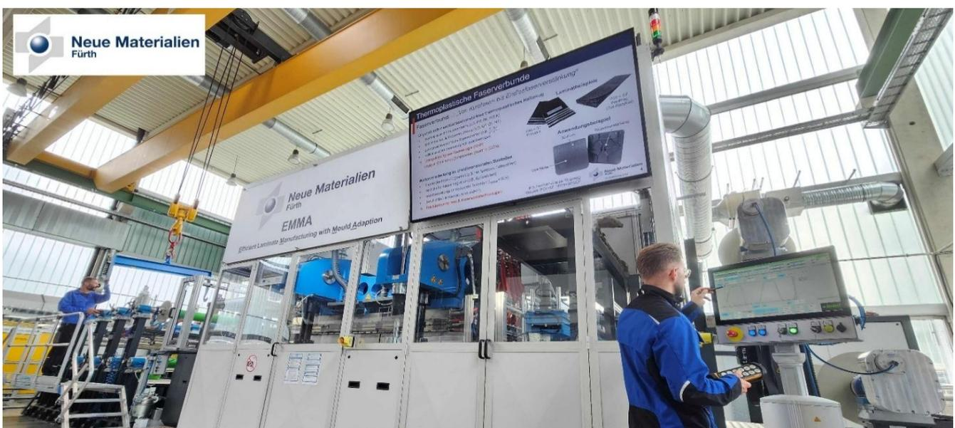
Abbildung 2: 50 Zoll Intervall-Heißpresse mit adaptiver Druckoptimierung und vollautomatischer Trennmittelstation im Technikum der Neue Materialien Fürth
