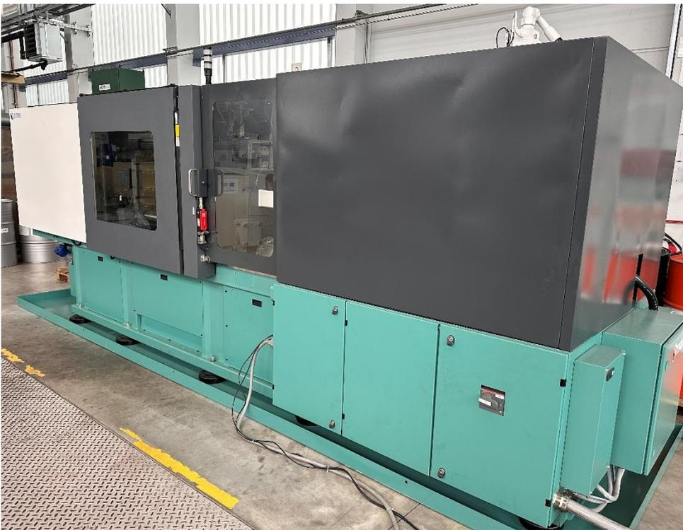
Abbildung 1: Horizontal-Kaltkammer-Druckgießmaschine; Standort: Neue Materialien Fürth GmbH.
