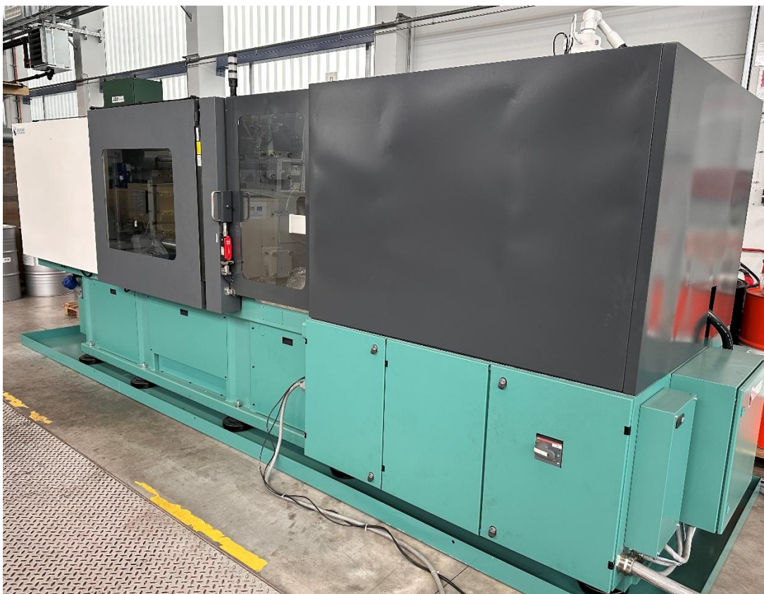
Image 1: horizontal cold chamber die casting machine; Location: Neue Materialien Fürth GmbH.
