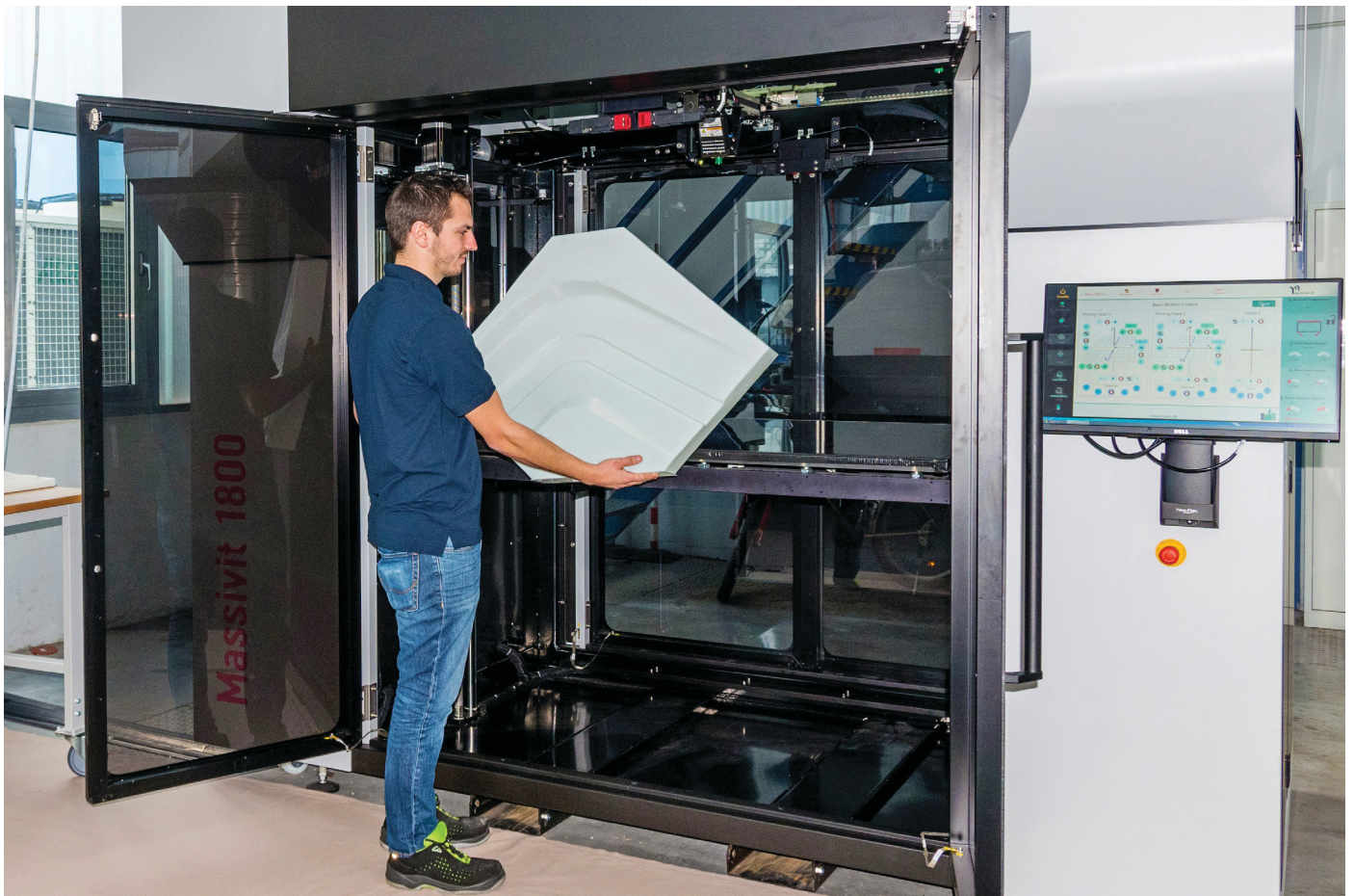
GDP-Drucker Massivit 1800 mit modifizierter Druckeinheit im Technikum der Neue Materialien Fürth
