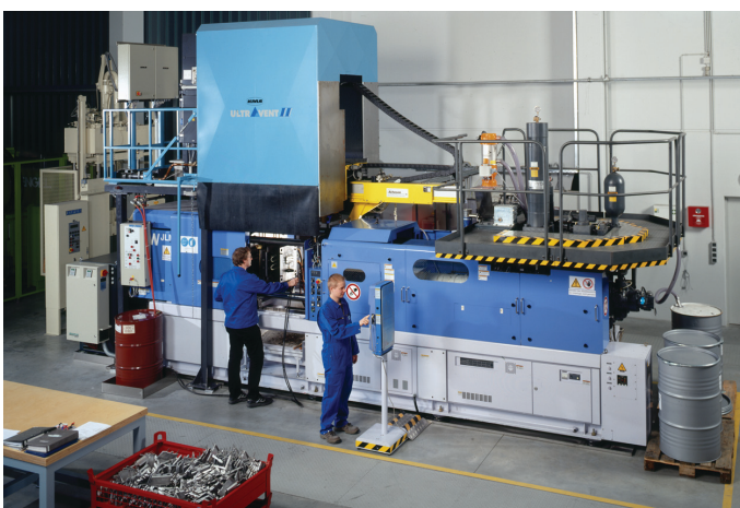
Bild 4: 220 t-Thixomolding-Maschine (JLM220MG, Fa. Japan Steel Works) bei NMF.
