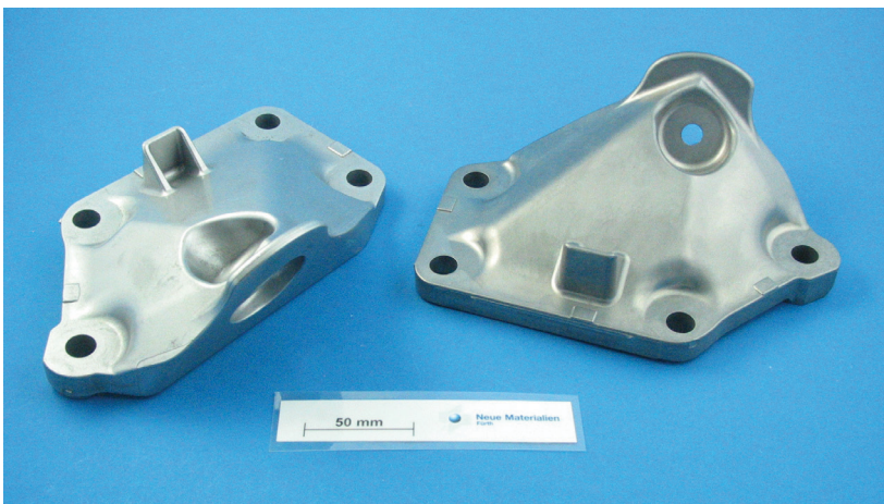
Bild 2: Am Beispiel eines Motortragbocks wurde die deutliche Verbesserung der Porosität durch Spritzgießen nachgewiesen.
