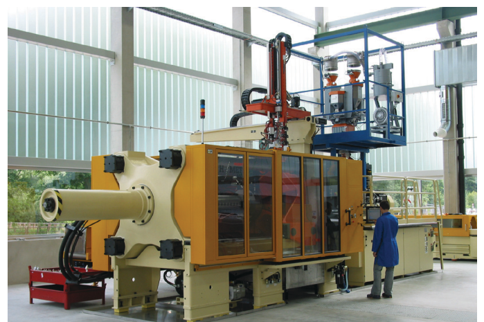
Bild 5: 650 t-Thixomolding-Maschine (HyMet650, Fa. Husky) bei NMF.
