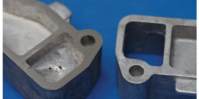
Beispiel Gusszustand nach Fräsen (links) und nass gleitgeschliffen (rechts)
