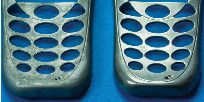
Beispiel Gusszustand (links) und nach einer trockenen Behandlung (rechts)
