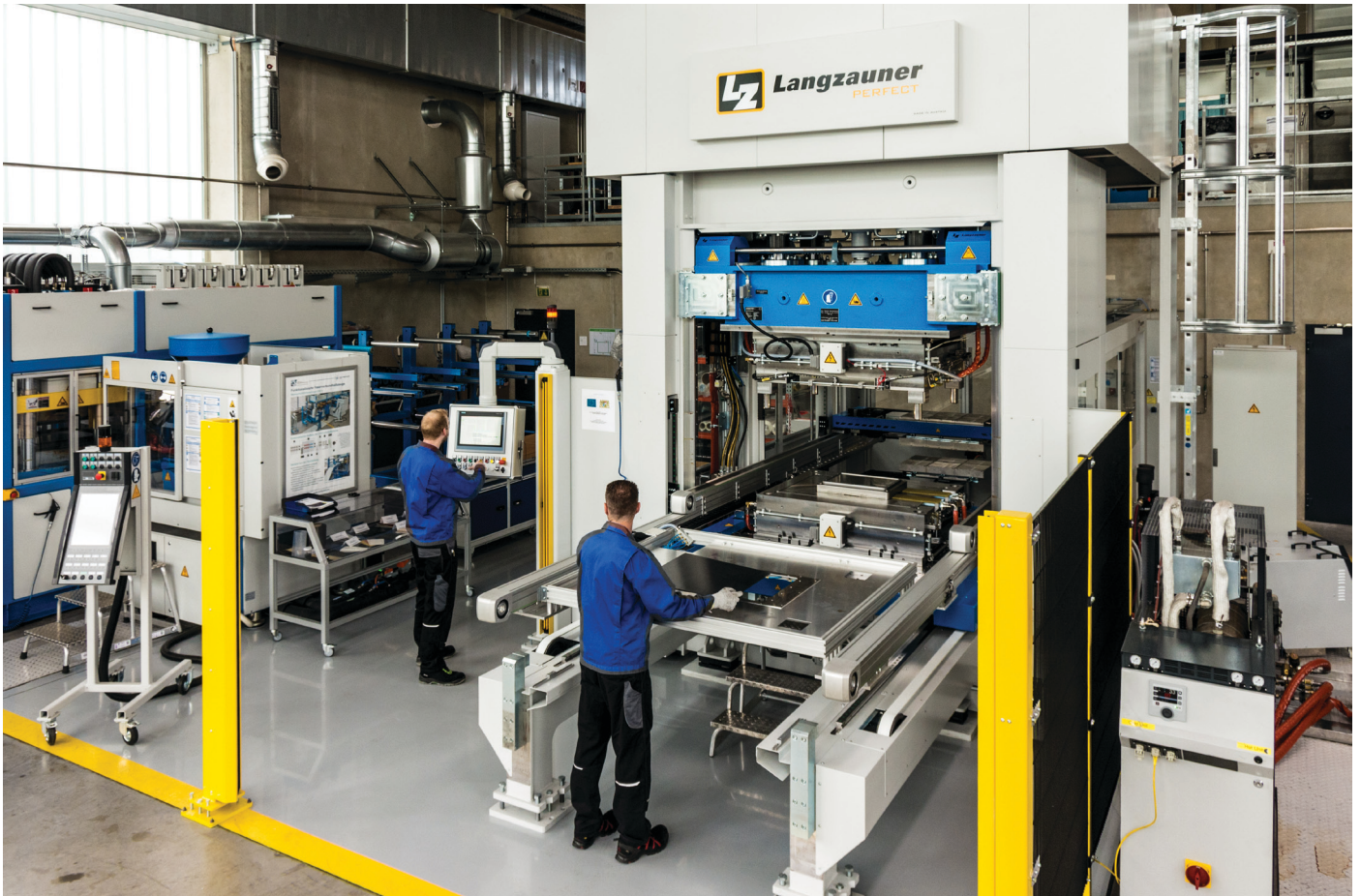
Präzisionsumformpresse mit Aufheizperipherie und Stammwerkzeug zur Herstellung nacharbeitungsfreier Leichtbauteile
