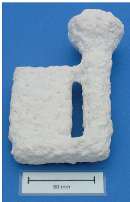
Reale und digitalisierte Formschalengeometrie im Vergleich: Durch die 3D-Vermessung von Formschalen mittels optischer Messsysteme kann ein exaktes Abbild der realen Formschale erzeugt werden. Die Schichtdickenverteilung ergibt sich durch die Vereinigung von Gusskörper und Formschale.
