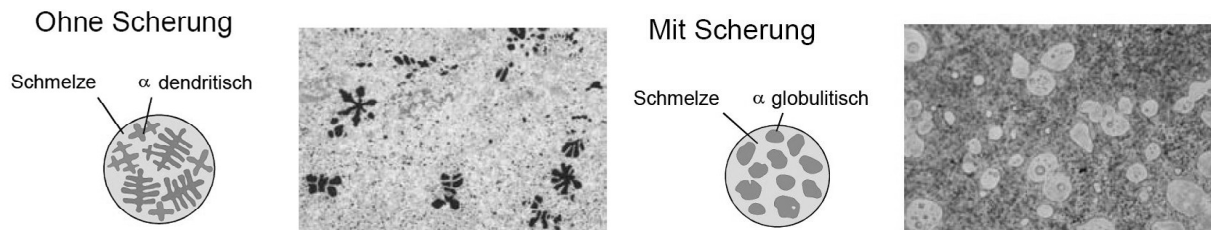
Bild 4: Unterschiedliche Gefügeausbildung ohne und mit Scherung von teilflüssigen Magnesiumschmelzen.
