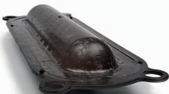
Probekörper „Kugel“ (oben) und „Zigarre“ (unten), hergestellt im Twin-O-Sheet-Verfahren.
