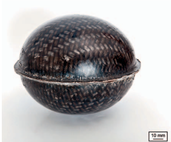
Probekörper „Kugel“ (oben) und „Zigarre“ (unten), hergestellt im Twin-O-Sheet-Verfahren.
