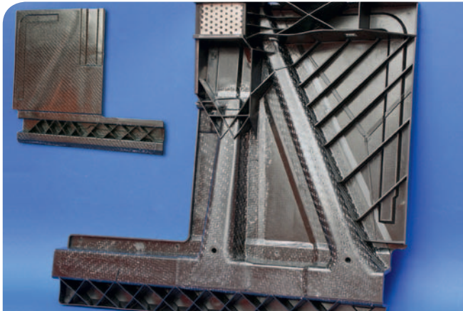
Rücksitzlehne aus PP-GF, gefertigt im FIT-Hybrid-Verfahren. Rechts sind Schnitte durch die beiden Hohlbereiche dargestellt.
