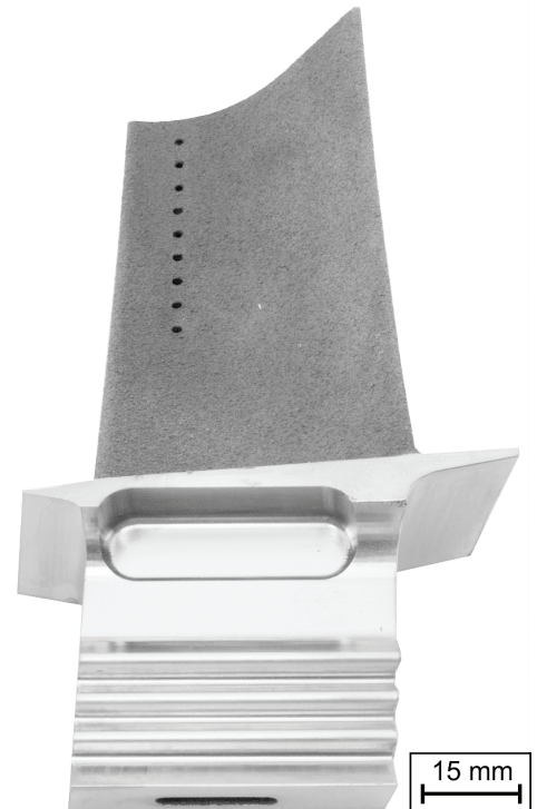
Additiv gefertigte Turbinenschaufel mit Kühlkanälen (Werkstoff: Ni-Basislegierung), Schaufelfuss ist mechanisch nachbearbeitet, Schaufelblatt im as-built Zustand
